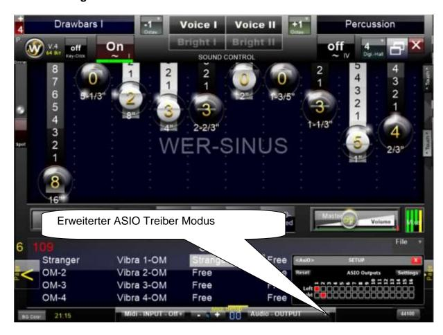
Sobald nun ein ASIO Treiber ausgewählt wird, steht ein 16 Kanal Routing zur Verfügung.
